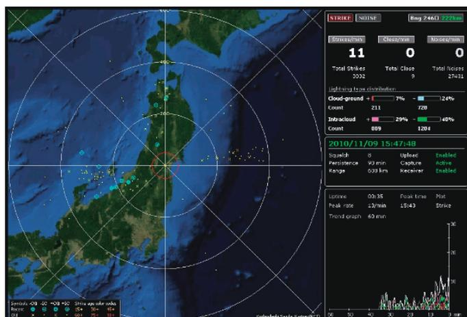
大気中において、雷雲の発生に伴い生じる電氣的現象の変化を捉えて発雷位置を想定し、地図上に示すシステムです。
