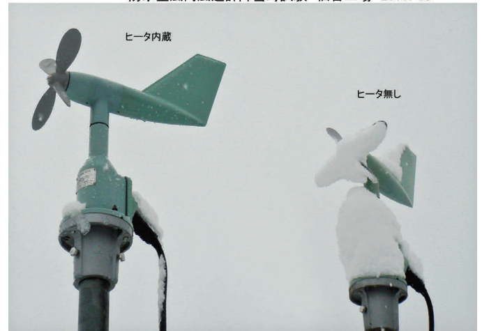
防水型風向風速計降雪時試験 仙台工場 2010. 03
