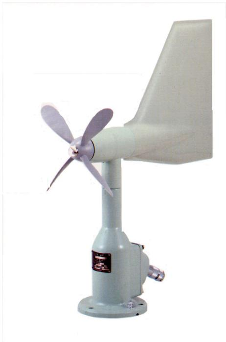
KVS-500 シリーズは独特の光技術と最新の技術が集積されたプロペラ型風向風速計で微風から強風までの広い測定範囲を持ち環境監視から防災まで幅広く採用されています。風速検出は光パルス、風向検出は光エンコーダの採用で完全ブラシレスを実現し耐久性にも優れています。
