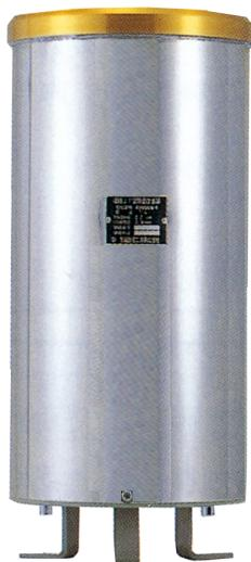
1転倒雨量1.0 mmの転倒ます型雨量計で、防災から治水管理まで、広い用途で採用されている標準的な雨量計です。
