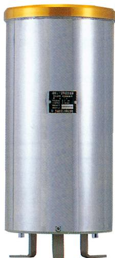
1 転倒 0.5 mmの転倒ます型雨量計で、防災から治水管理まで、広く使用されている標準的な雨量計です。
