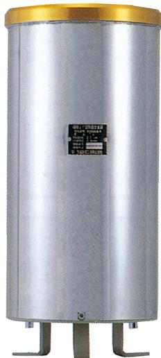
1転倒雨量0.5mmの転倒ます型雨量計で、防災から治水管理まで、広い用途で採用されている標準的な雨量計です。
