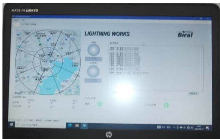
雷検知システム 監視画面
