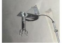
気象業務法のもとで行われる検定において、日本で最初に測定範囲0～90m/sまでをカバーした製品です。（写真はトンネル用の事例）
