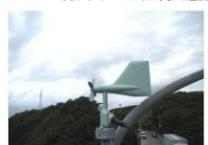
風向風速計発信器の内部に電気回路が一切使われてない事から、強電界や雷等の影響を受けない風向風速計です。（写真は雷災対策として設置された例）
